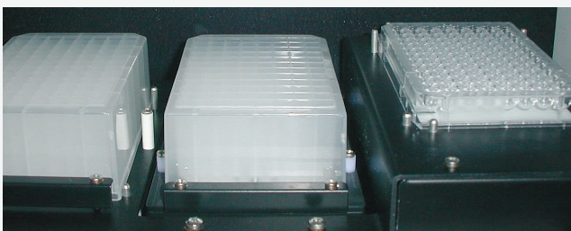
그림 3 T1000에 시약·소모품 세팅한 모습
