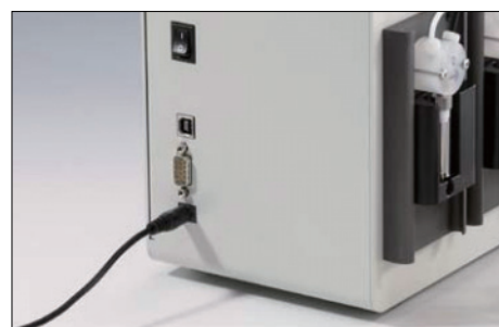
그림 3. Sirius L supports both USB and RS-232 data port.
